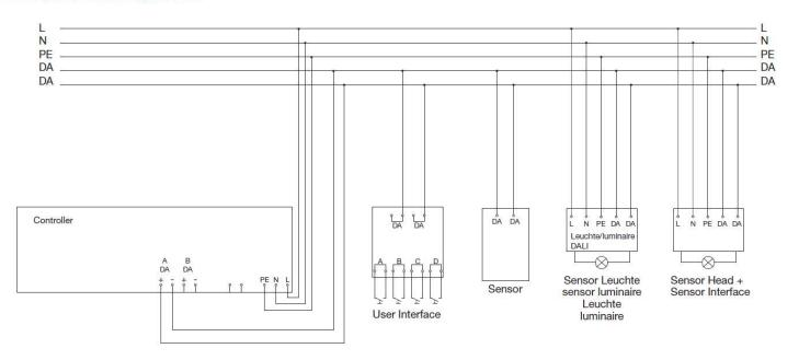
Die obige Darstellung zeigt nur einen exemplarischen Schaltplan eines Lichtmanagementsystems. Für einen konkreten Anwendungsfall ist zwingend eine individuelle Planung (insbesondere Leitungs- und Stromkreisdimensionierungen, Leitungsarten, Brandschottungen, Trassenführungen, etc.) durch qualifiziertes Personal erforderlich. Die Siteco GmbH übernimmt keinerlei Haftung für die Richtigkeit der obigen Darstellung
