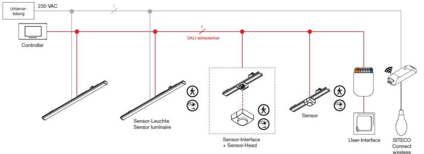
Die obige Darstellung zeigt nur einen exemplarischen Schaltplan eines Lichtmanagementsystems. Für einen konkreten Anwendungsfall ist zwingend eine individuelle Planung (insbesondere Leitungs- und Stromkreisdimensionierungen, Leitungsarten, Brandschottungen, Trassenführungen, etc.) durch qualifiziertes Personal erforderlich. Die Siteco GmbH übernimmt keinerlei Haftung für die Richtigkeit der obigen Darstellung
